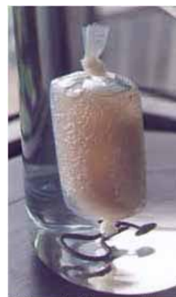
Polímero sintético comercial, insoluble en agua, sobre el que se realizó una transformación de los substituyentes. Adquiere aspecto de gel con mayor grado de conversión
