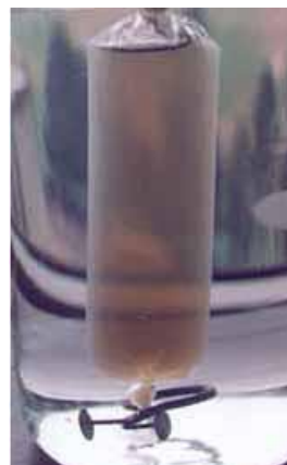
Polímero sintético comercial, insoluble en agua, sobre el que se realizó una transformación de los substituyentes. Bajo grado de conversión, se muestra casi insoluble
