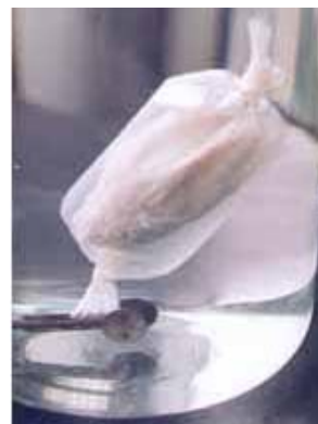
Polímero sintético comercial, insoluble en agua, sobre el que se realizó una transformación de los substituyentes. Grado de conversión casi total, y resulta un producto soluble en agua
