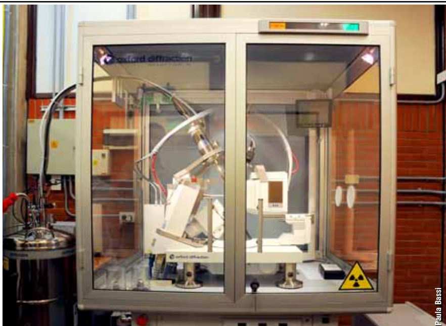
Nuevo difractómetro de rayos X para estudiar monocristales. Permite realizar en minutos u horas estudios que demoraban días con los equipos antiguos existentes en el país.
